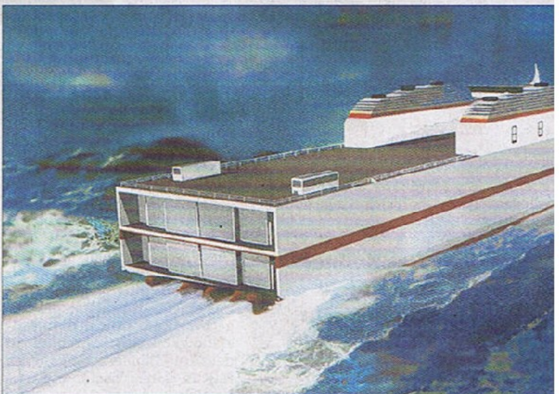
So wie auf dieser Illustration sollen in wenigen Jahren Jet-Schiffe für den Containerverkehr den Atlantik in knapp vier Tagen überqueren. Für Schnelligkeit werden eine neue spitzere Bugform, breitere Heckflossen und eine neue
